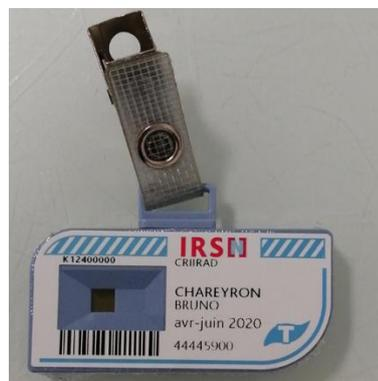
Exemple de dosimètre passif avec système d'attache
